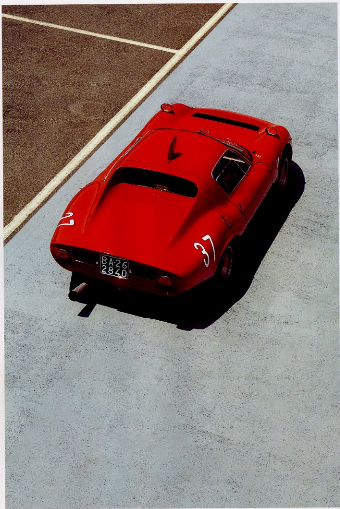
Abarth 1300 OT, prima serie, 1967: la caratteristica presa d'aria a periscopio portava refrigerio ai piloti nelle gare di durata
